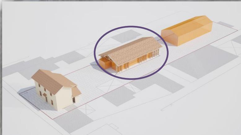
**Réhabilitation du hangar\*** d'une surface de 220 m<sup>2</sup> avec une phase de consolidation et de remplacement de quelques pièces de charpente.
